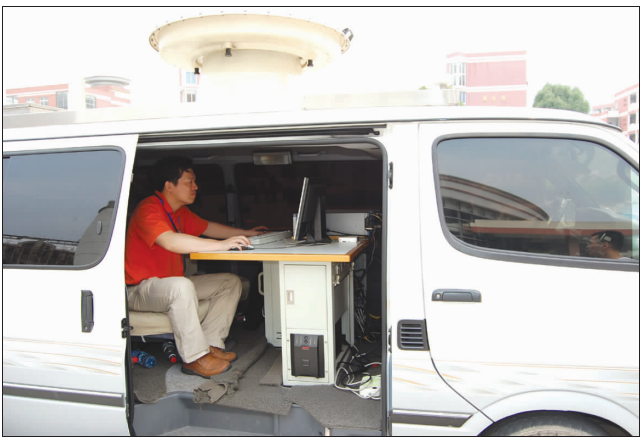
车内的无线电检测装置,能准确地发现无线电波,还可对手机等通讯设备进行干扰。
